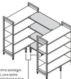
Usare quattro sostegni centrali, uno sotto ciascuna unità base e due sotto il ripiano intermedio inferiore.
