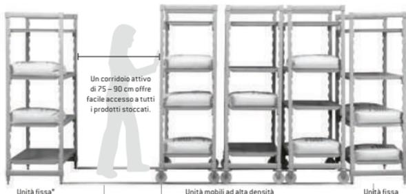
I binari permettono una facile movimentazione delle scaffalature mobili. I binari in alluminio e il kit di montaggio in acciaio inossidabile sono resistenti alla ruggine. \*Si raccomanda di usare un'unità fissa per ogni 4,5 m di binario per stabilizzare ulteriormente il sistema.
