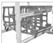
**NOTA:** Ciascun livello di cestello per barattoli richiede 3 traverse, 2 anteriori e 1 posteriore. Prima di installare la traversa/livello successivo, lasciare aperti due incastri sopra la traversa superiore. Ciò consentirà di avere spazio sufficiente per inserire i barattoli.
