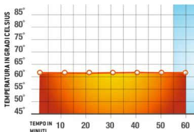
Per il mantenimento ottimo della temperatura, riscaldare il piatto del cibo a +90°-100 °C prima di riempirlo con cibo caldo a circa 85 °C.
